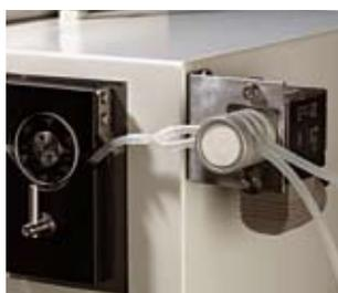
Позволяет выполнять автоматическое переключение между чистым растворителем и образцом, исключая необходимость ручной замены соединительных шлангов. Рекомендуется использовать в сочетании с блоком дистанционного управления (входит в комплект B-290 Advanced).
