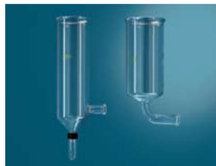
Две различных по геометрии стеклянных сушильных камеры позволяют оптимизировать выход продукта в зависимости от процесса. Цилиндр с боковым выходным отверстием подходит в частности для водных продуктов, которые требуют больше времени на осушку, в то время как цилиндр второго типа с вертикальным выходным отверстием особенно полезен для работы с органическими растворителями.
