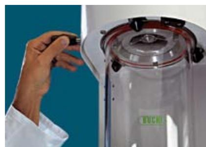
Сборка стеклянных частей происходит на удивление быстро, просто и элегантно. Стеклянный цилиндр вставляется на место всего лишь одним движением затворного рычага.
