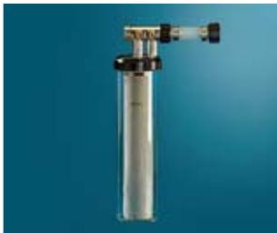
Выходной фильтр в сборе, в комплекте со сменным фильтром из полиэстера и манометром, отображающим перепад давления. Обеспечивает оптимальную защиту аспиратора. В комплект поставки входит также мешотчатый фильтр из пористого политетрафторэтилена. Он позволяет легко отделять мельчайшие фракции от материала фильтра, тем самым увеличивая общий выход продукта.
