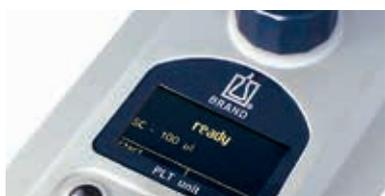
**Прибор для проверки герметичности дозаторов**
