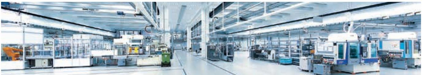
Расходные материалы BRAND для биологических исследований производятся при использовании самых современных технологий, в одном из крупнейших в мире чистом помещении для производства лабораторных расходных материалов. Непрерывный мониторинг чистого помещения включает, кроме всего остального, постоянные замеры количества частиц в воздухе, избыточного давления воздуха, кратности воздухообмена, температуры и относительной влажности в помещении.
