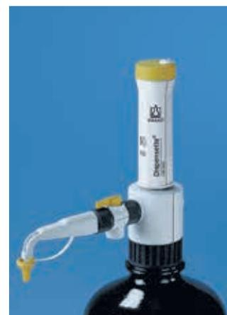
\* Калибровка по дозированию (TD, Ex). Пределы погрешности, соответствующие номинальному объему (= максимальному объему), указанному на приборе, получены при тестировании с дистиллированной водой при постоянной температуре в помещении 20 °С и плавном равномерном дозировании. Пределы погрешности должным образом соответствуют требованиям DIN EN ISO 8655-5. Обозначение DE-M.
