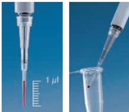
Микродозаторы Transferpette® 0,1-1 мл, Transferpette® S 0,1-1 мкл и Transferpette® S 0,1-2,5 мкл могут использоваться для дозирования микрообъемов до 0,1 мкл с высочайшей точностью.
