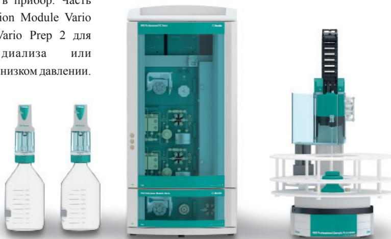
В случаях, когда три, четыре или больше анализов запускаются параллельно, необходимо наличие насоса высокого давления или нескольких идентичных аналитических каналов - 940 Professional IC Vario в комбинации с 942 Extension Module Varion может быть адаптирован под Ваши требования. Например, при параллельном анализе анионов, образец может быть удвоен и пригодность системы повышается.
